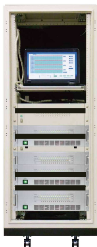
※写真は14ch×4Unitの56chPMSラックシステム
